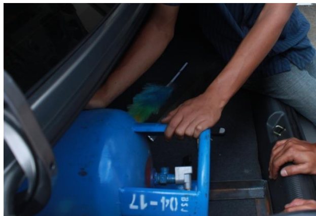
Gambar 5 Pemasangan tabung kemasan dan braket pada bagasi belakang
