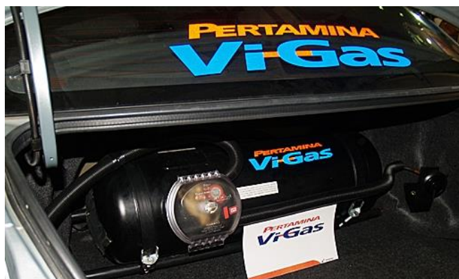
Gambar 6 Posisi tabung LPG jenis refill pada bagasi sedan dengan braket kombinasi rangka besi dengan sabuk karet.
