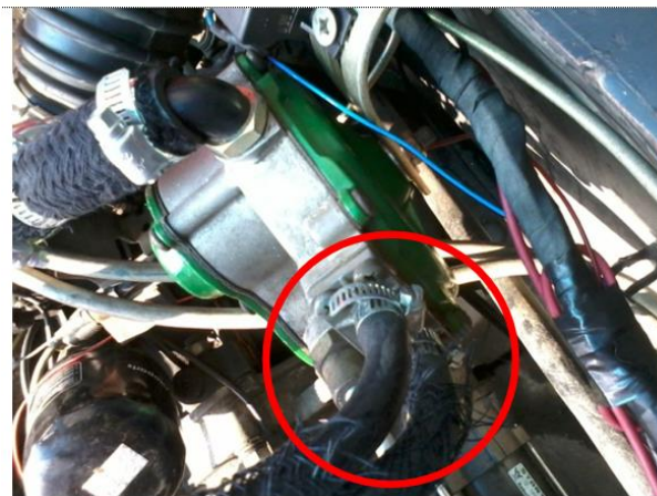
Gambar 1 Vaporizer dengan selang air (water house) berukuran kecil
