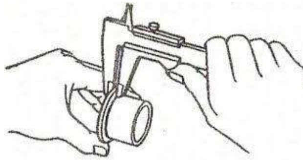
Gambar 2.7 Mengukur Pengukuran Ketebalan Flens.
